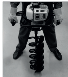
7 сурет. Мотобұрғымен жұмыс жасағанда оператордың дене қалпы
